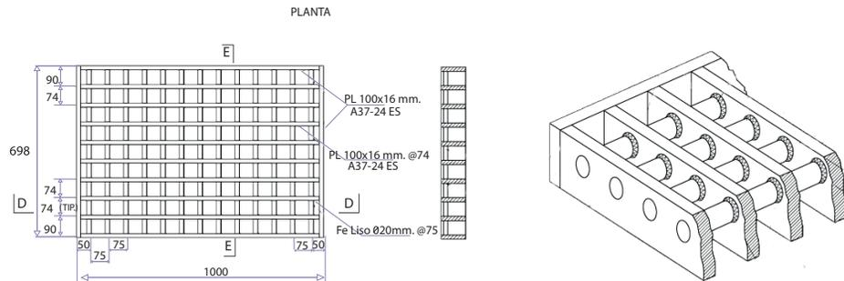
SUMIDERO TIPO D.O.H. Fabricado de acuerdo a EE.TT. del D.O.H
