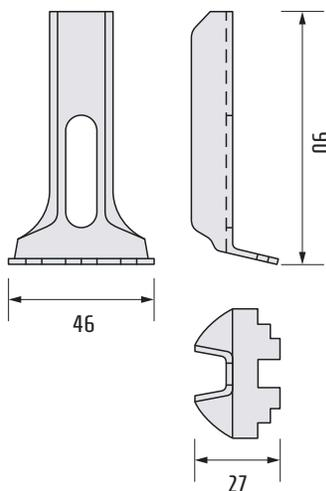
La fijación Clip "L" consta de una placa "W" ondulada de 3mm de espesor que aprisiona la parte superior de dos pletinas soportantes de la parrilla, una pieza "L" con un extremo dentado para mejor acomodo con las pletinas y un perno M8 x 70mm. Grado 4.8 con su tuerca, todo galvanizado en caliente.
